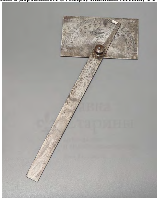
Старинный транспортир, угломерный инструмент General № 17, Hardware Mfg. Co., США, нач. 20 в. Фото с сайта
